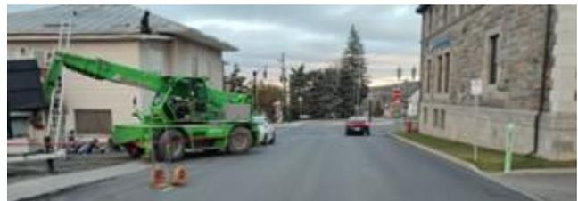
Photo 4 – Approche ouest - Absence de trottoir du côté sud. Visibilité limitée aux quadrants nord-est et sud-est en raison de la présence de bâtiments.
