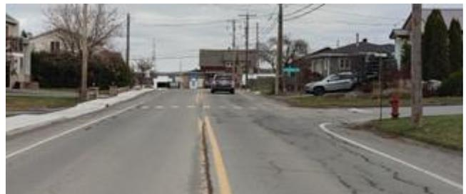
Photo 2 – Passage pour piétons non conforme au niveau de la rue Lebel, celui-ci doit être accompagné de panneaux P-270.
