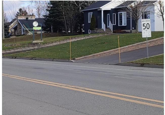
Photo 1 – Panneau d'affichage de limite de vitesse à proximité de l'A-85. Plus d'un panneau sur un même support, non conforme.
