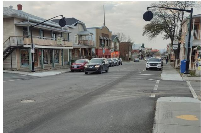
Photo 6 – Vue approche nord – Proximité des cases de stationnement de l'intersection réduit la visibilité des piétons.
