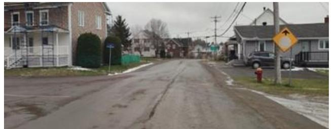
Photo 2 – Intersection rue Deschênes / rue de l'Église. Signal avancé d'arrêt alors qu'il n'y a pas d'arrêt sur la rue Deschênes à l'intersection avec la rue Bernier.
