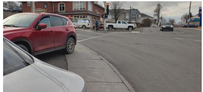
Photo 3 – Quadrant sud-est de l'intersection rue Fraser / rue Lafontaine. Des véhicules stationnés bloquent le trottoir et obstruent la visibilité du coin de rue.
