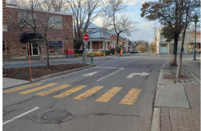
Photo 1 – Présence d'un passage pour piétons derrière la ligne d'arrêt; aménagement non conforme.
