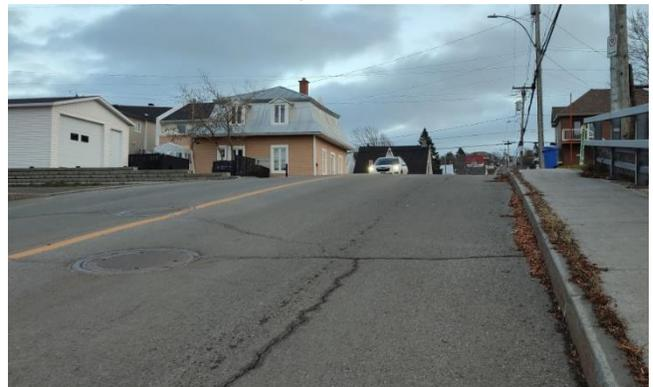
Photo 3 – Approche nord - Distance de visibilité d'arrêt limitée en raison de la pente.
