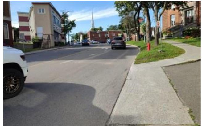
Photo 1 - Approche sud - Baie de virage à gauche nécessitant le décalage d'une voie. Absence d'espacement entre la voie de circulation et la bordure surélevée.
