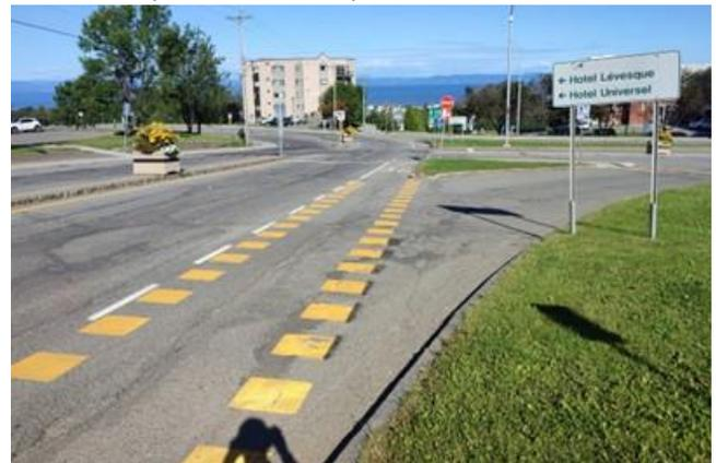
Photo 4 - Approche sud - Panneau « Arrêt » non conforme. Panneau d'indication non conforme.
