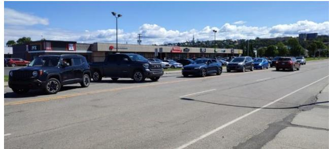
Photo 6 – Boulevard Armand-Thériault au niveau des accès du PFK et Tim Hortons – Visibilité d'insertion obstruée par le stockage de véhicules.
