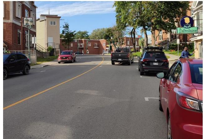
Photo 2 – Approche sud - Distance de visibilité des têtes de feu insuffisante (75 m).
