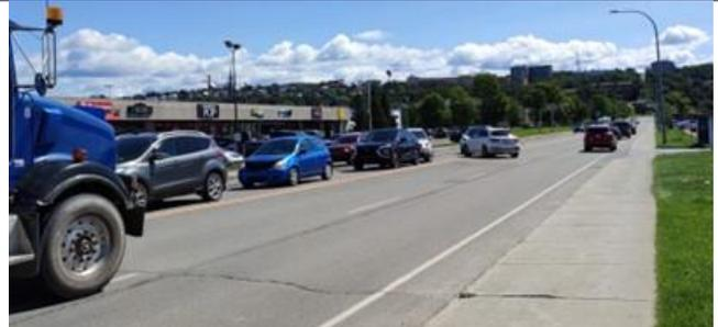
Photo 7 – Boulevard Armand-Thériault au niveau de l'entrée de Pizza Salvatore – Visibilité du virage à gauche obstruée par le stockage de véhicules.
