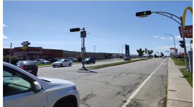
Photo 1 - Approche est - Panneaux « Direction des voies » (P-100) positionnés en aval de l'intersection. Tête de feu manquante pour le mouvement principal.
