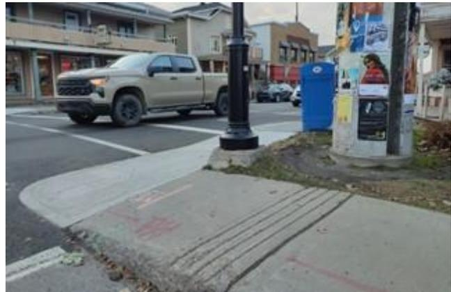
Photo 3 - Approche est - Distance de visibilité d'arrêt insuffisante en raison de la pente. Affichage publicitaire obstrue la visibilité.
